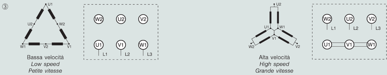
DOPPIA VELOCITÀ, DAHLANDER, COPPIA COSTANTE TWO SPEED, DAHLANDER, COSTANT TORQUE BI-VITESSES, DAHLANDER, COUPLE CONSTANT
